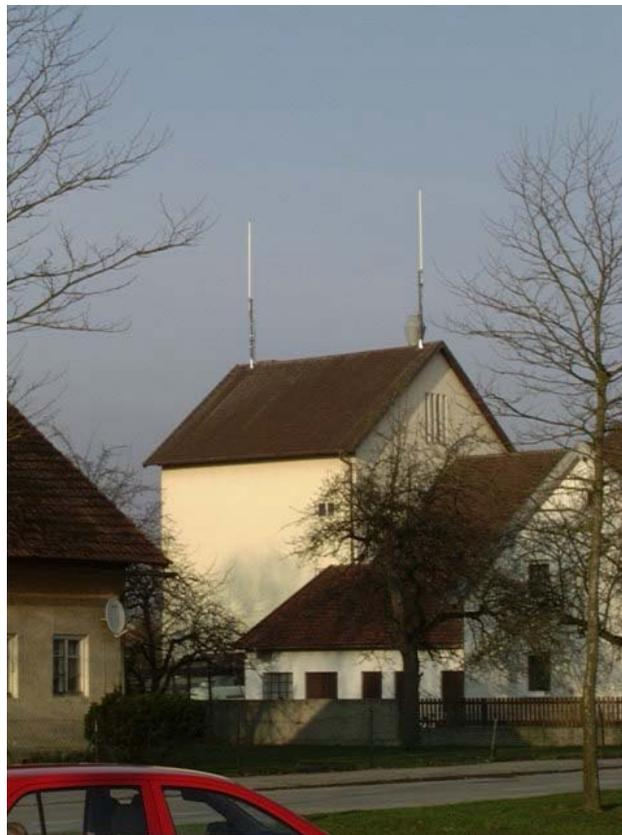
**Abb. 1:** Beispiel für eine Mobilfunksendeanlage mit omnidirektionalen Antennen.
