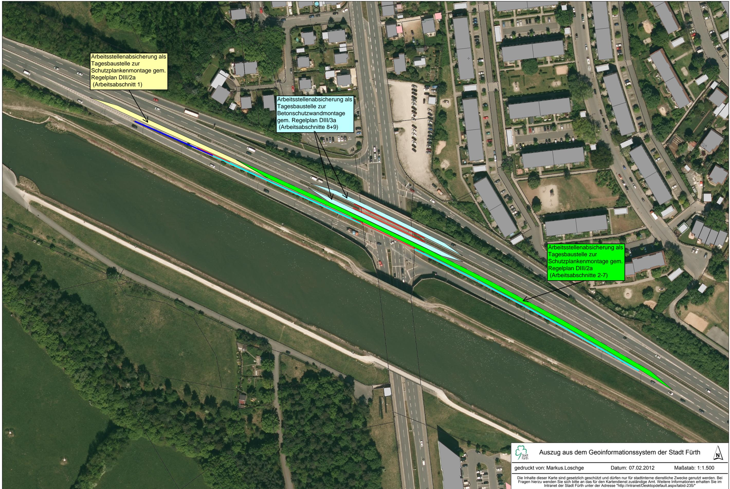
Arbeitsstellenabsicherung als Tagesbaustelle zur Schutzplankenmontage gem. Regelplan DIII/2a (Arbeitsabschnitt 1)
