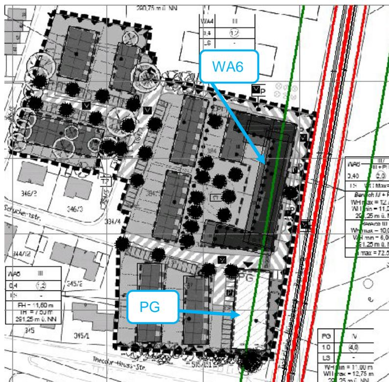
Abb. 8: Bereiche der Überschreitung der Störfestigkeitsrichtwerte für Industrie (rot) und Wohn- bzw. Gewerbeumfeld (grün), Berechnungshöhe 1 m (oben) und 6 m (unten).
