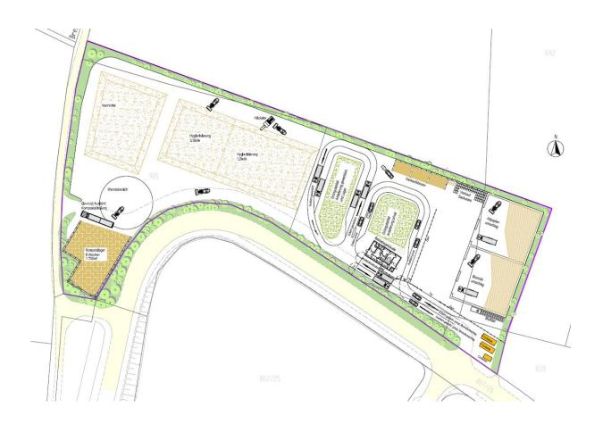
Für das Konzept VIII wird eine Fläche östlich der vorhandenen Kompostieranlage hinzugenommen. Dort werden – getrennt von der Grüngutanlieferung und dem Rottebetrieb – die Hallen für Biogut und Papierumschlag errichtet. Im Norden wird das bestehende Grundstück durch eine zusätzliche Fläche begradigt.
