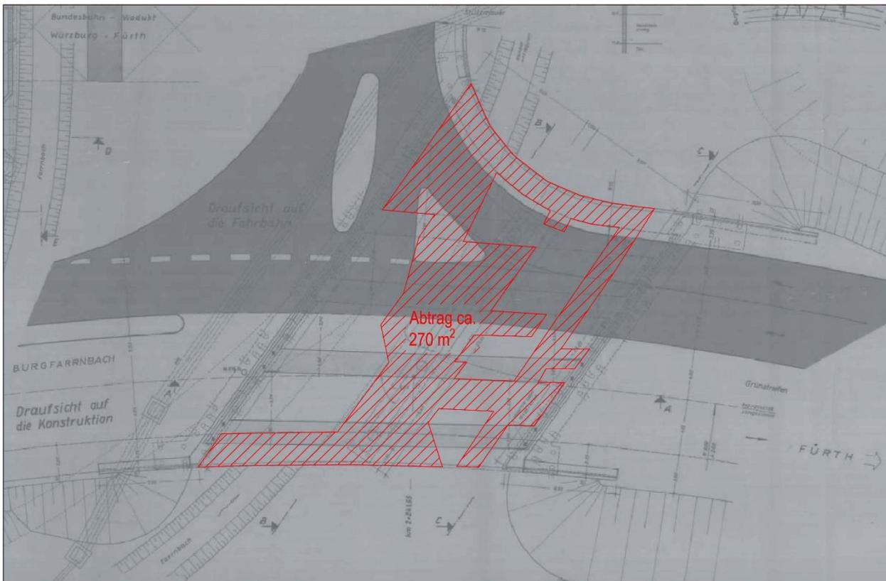
Die Arbeiten können nur ausgeführt werden, wenn die Tragkonstruktion vollflächig entlastet ist. Hierzu ist eine aufwändige Traggerüstkonstruktion herzustellen, die zusätzlich als Schutz- und Arbeitsgerüst auszubilden ist.
