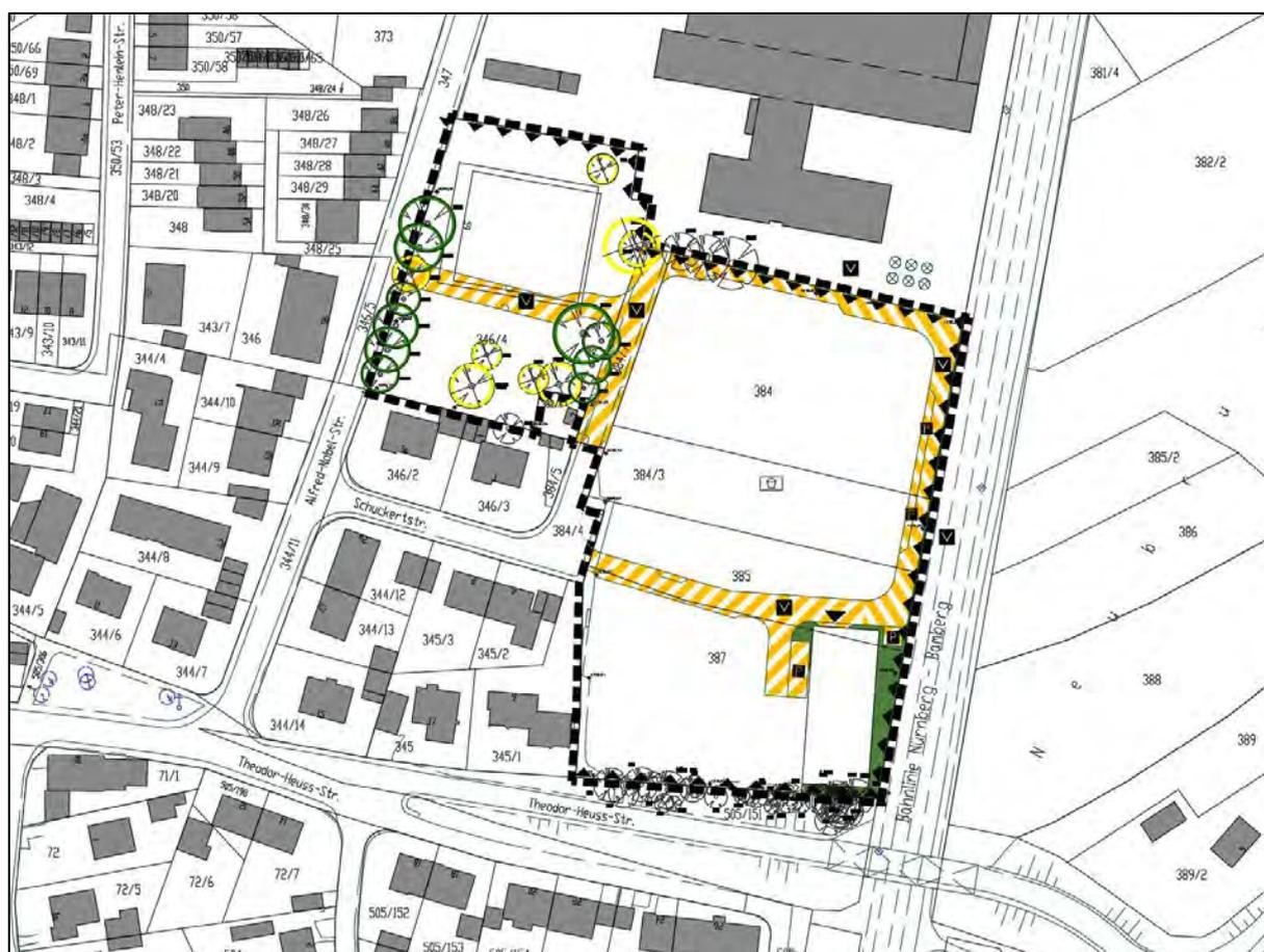
Lageplan mit Darstellung der geplanten Verkehrsanlage (gelb schraffierte Fläche)
