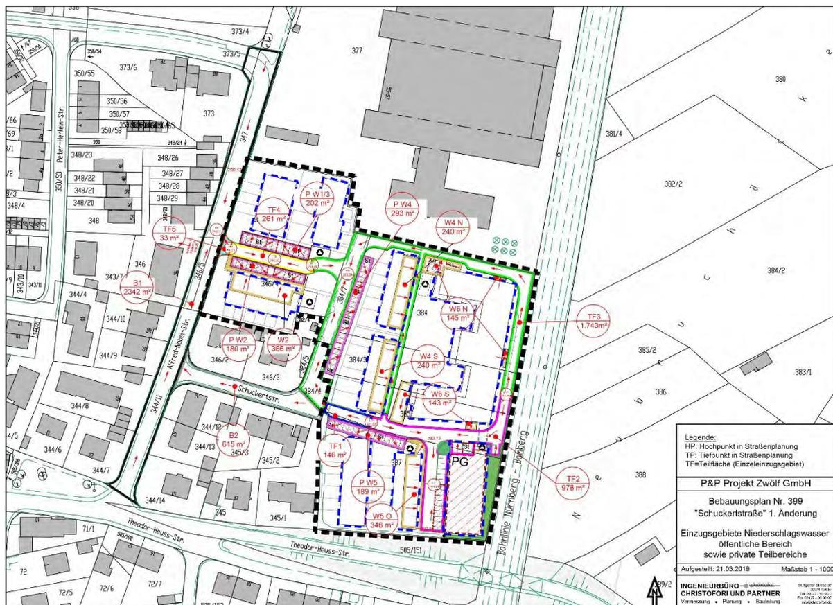
Verkleinerung der als Anlage beigefügten zeichnerischen Darstellung beigefügten Ermittlung der maßgeblichen Teileinzugsflächen sowie Hoch- und Tiefpunkte der gepl. Straßen
