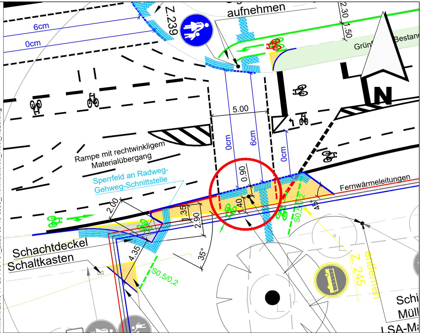
Aufgrund der Unterschreitung des von der INFRA geforderten Mindestabstandes von 1,50 m zwischen LSA-Mast-Fundament und Fernwärmeleitung sind Schutzmaßnahmen zu treffen, die einer Beschädigung der Leitung entgegenwirken, einen Beschädigungsfall ohne Zeitverzug erkennen lassen und dessen umgehende Behebung sicherstellen. Hierzu sind die Freilegung der Fernwärmeleitung während des Fundament- und Mast-Aufbaus und ein Beweissicherungsverfahren durchzuführen.
