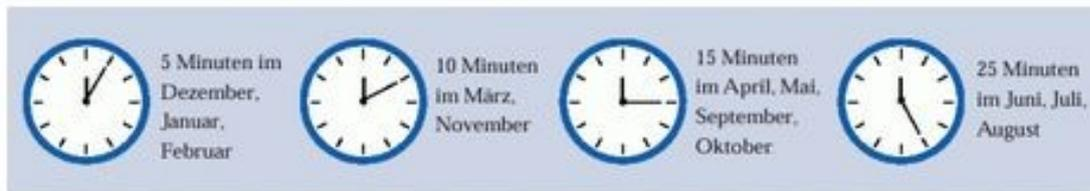
Abb. 5: Je kälter es draußen ist, desto kürzer kann gelüftet werden<sup>20</sup>
