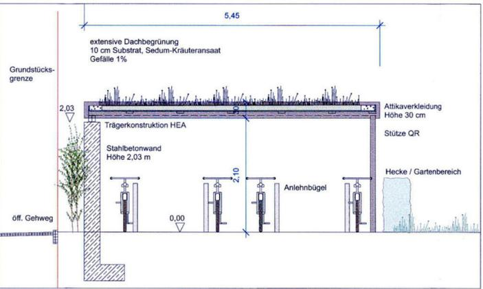
Schnitt E Fahrradüberdachung M 1:50
