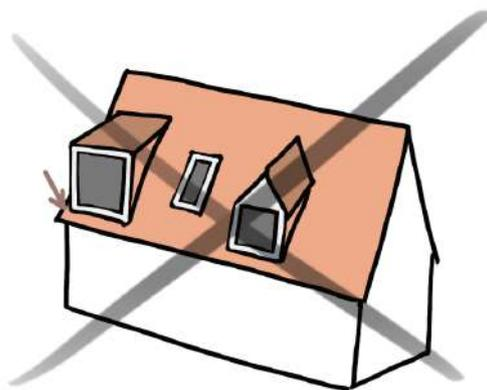
**Dachflächenfenster** können bei übermäßiger Verwendung zu einer regelrechten Durchlöcherung der Dachfläche führen. Sie sollten nur reduziert und geordnet vorkommen und möglichst flächenbündig in die Dachfläche, ohne hohen, breiten Aufsatzrahmen eingebaut werden. An die Dachfläche angepasste Farben sind zu empfehlen.
