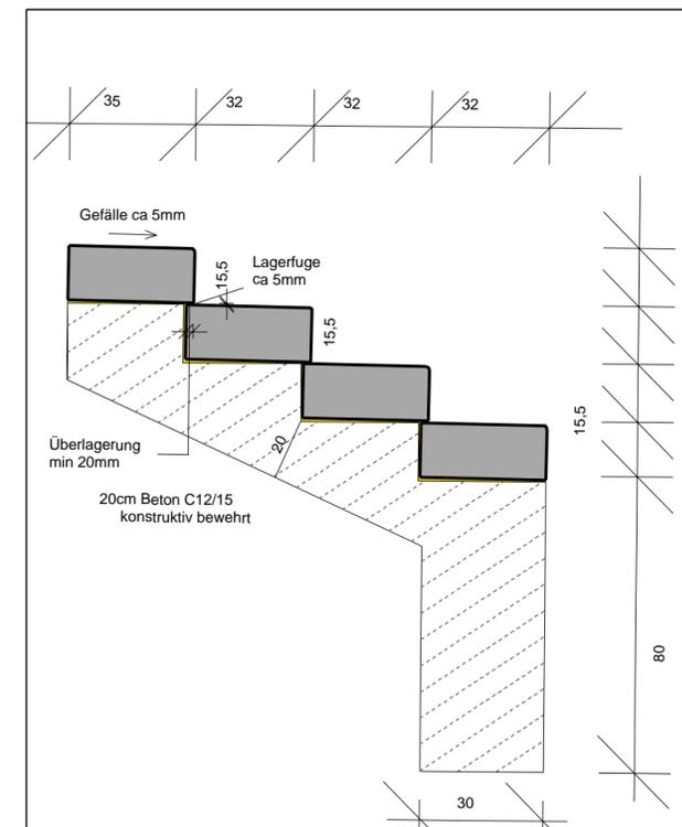
Stufendetail Maßstab 1:17
