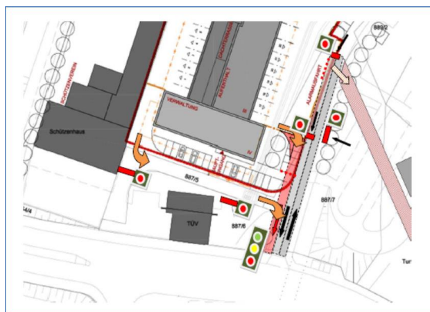
Systemskizze der Feuerwehrausfahrt (Quelle ABK)
