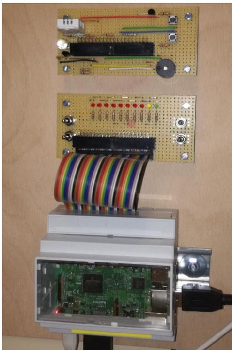
Serverraumüberwachung und Grundenschulung mit dem Raspberry Pi im Hutschienengehäuse
