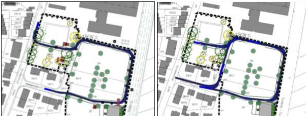
Auszug Schleppkurvenprüfung (Links 3-Achsiges Müllfahrzeug, rechts: Lastzug, jeweils Fahrweise 1 nach FSGV)
