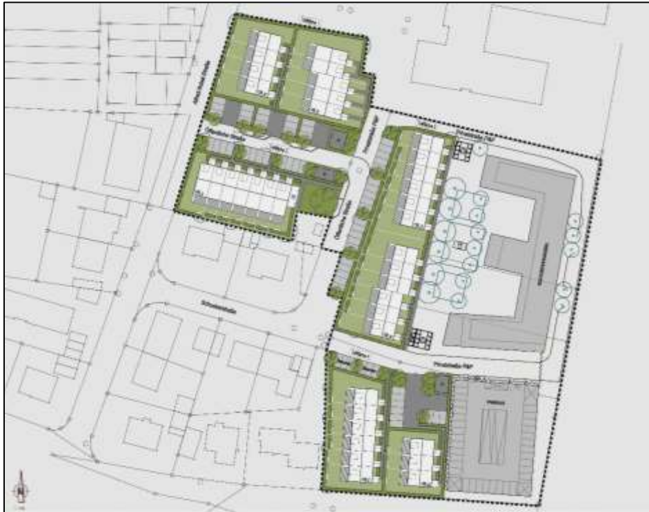
Variante mit lärmabschirmender Randbebauung nach Osten und großer Quartiersgarage für das städtebauliche Umfeld
