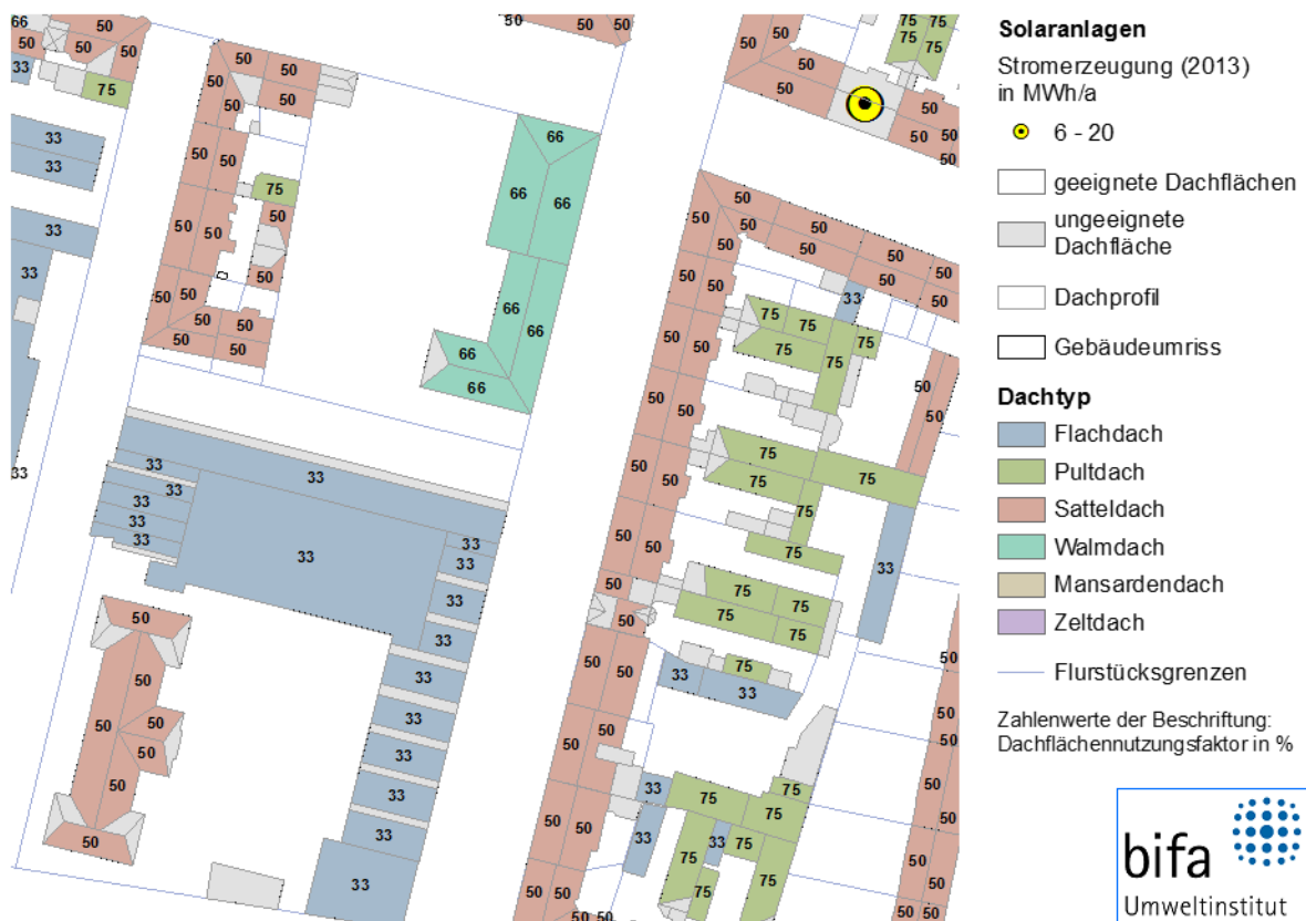
Abbildung 52: Ausschnitt Dacheignung für Solaranlagen
