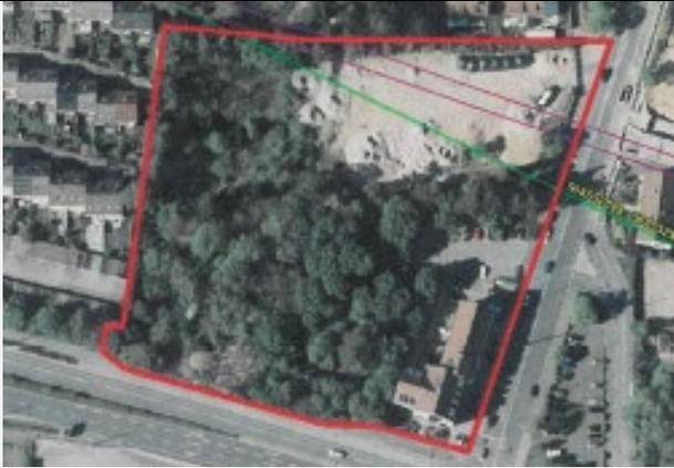
*Die farbige Linie versteht sich als Punkt-zu-Punkt-Richtfunkverbindung der Telefónica Germany GmbH & Co. OHG. Das Plangebiet ist im Bild mit einer dicken roten Linie eingezeichnet.*
