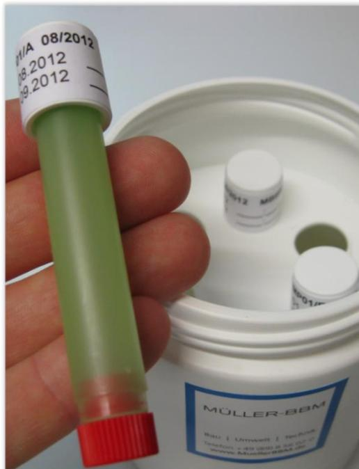
Abbildung 8. NO<sub>2</sub>-Passivsammler mit Witterungsschutzgehäuse (Nahaufnahme).
