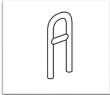
Abb. 4: Anlehnbügel (aus: Planungshilfe für Abstellanlagen von Lastenfahrrädern im öffentlichen Raum (ALADIN, 2022), verändert)
