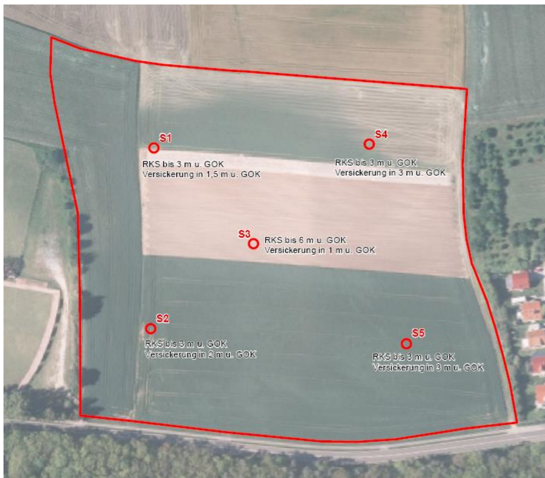
Abbildung 2: Lage und Beschreibung der Versickerungsversuche im geplanten Baugebiet (R&H Umwelt, 2018).
