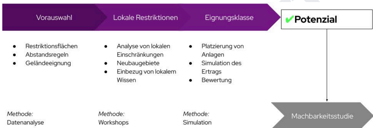
Abbildung 21: Vorgehen bei der Ermittlung von erneuerbaren Potenzialen
